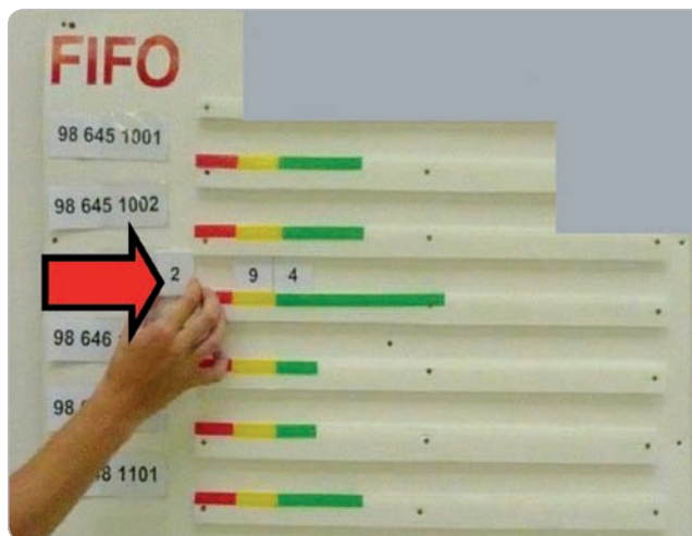
Obr. 12 Zmena stavu tabule FIFO po spätnom uvoľnení dielov
