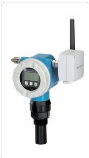
Obr. 3 Adaptér WirelessHART natrvalo zmodernizuje zariadenie HART na zariadenie s bezdrôtovou komunikáciou WirelessHART. Ak je to potrebné, adaptér zároveň prostredníctvom zabudovanej batérie zabezpečí aj napájanie
